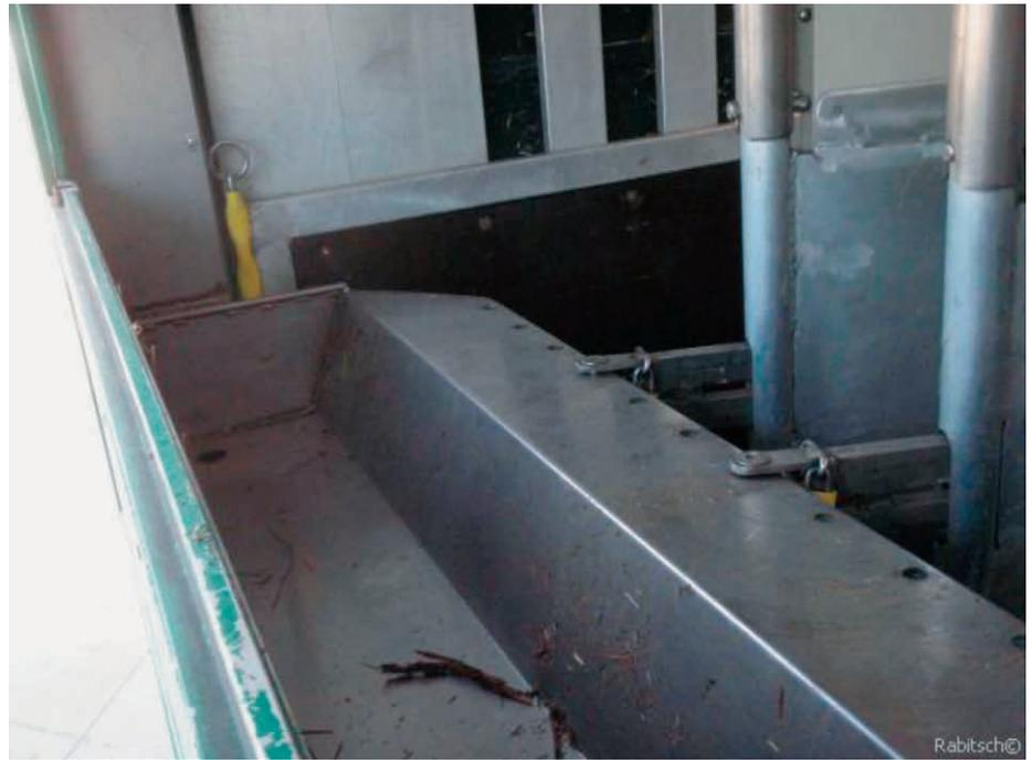
**Abb. 16:** Verordnungskonforme [VO (EG) 1/2005], fix eingebaute Tränke mit Direktanschluss an den Wasservorratsbehälter beim Transport von Pferden in Einzelständen. Die hier abgelichtete Wannentränke dient außerhalb der Tränkezeiten auch der Futtervorlage.
